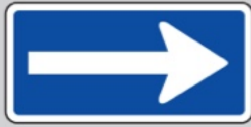
S-12 TRAMO DE CALZADA DE SENTIDO ÚNICO
