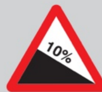
P-16a BAJADA PELIGROSA
