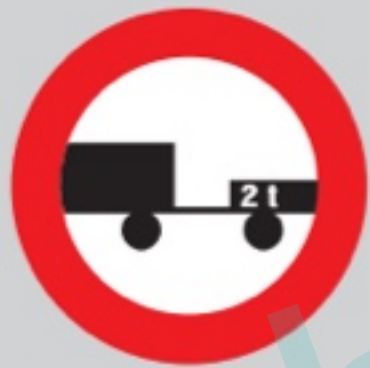
R-112 ENTRADA PROHIBIDA A VEHÍCULOS DE MOTOR CON REMOLQUE QUE NO SEA UN SEMIRREMOLQUE O UN REMOLQUE DE UN SOLO EJE
