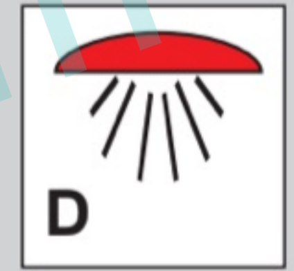
SM-943 ESPACIO PROTEGIDO POR SISTEMA DE EMPAPE
