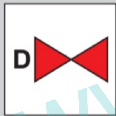
SM-944 SECCIÓN VÁLVULAS SISTEMA DE EMPAPE
