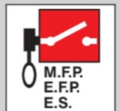
SM-935 BOMBA E INTERRUPTORES CONTROLADOS A DISTANCIA
