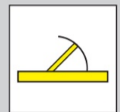
SM-967 PUERTA DE INCENDIO CLASE B
